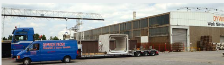
160 Schwertransporte: Streckenweise wurde bei der Beförderung der über 3 Meter langen Fertigteile auf der genehmigungspflichtigen Route vom Herstellerwerk zur Baustelle behördlich der Einsatz von Begleitfahrzeugen (BF 2) vorgeschrieben.
