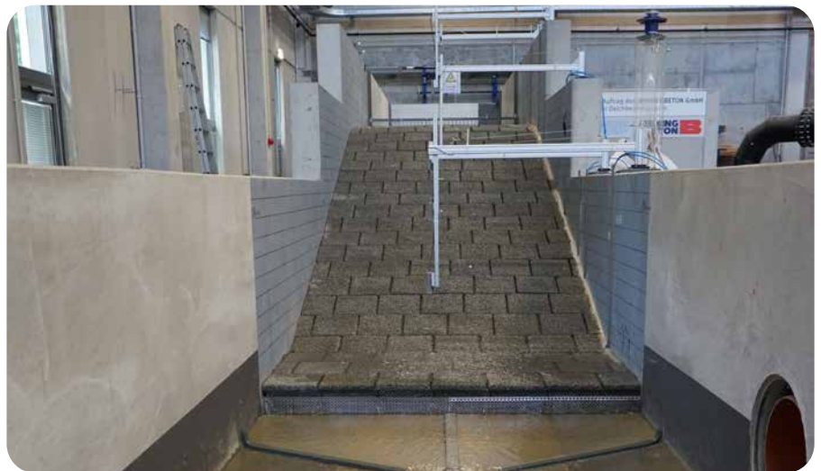
Der Modelldeich des Instituts für Wasserbau und Wasserwirtschaft, Aachen ▲
