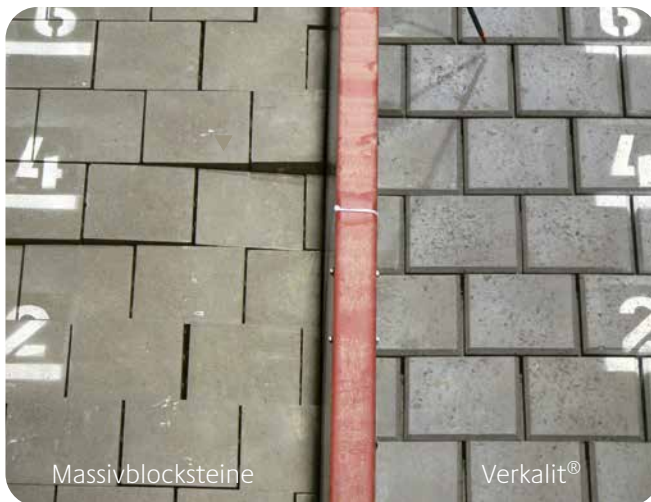
◀ Zustand nach 15 Std. Wellenbeaufschlagung
