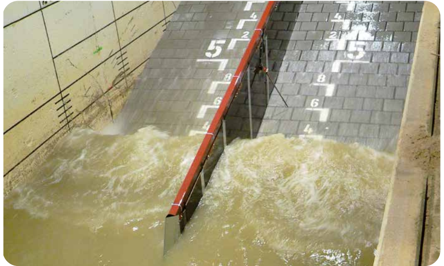
▲ Langzeitbelastung mit auflaufender Welle; Massivblocksteine links Verkalit® rechts
