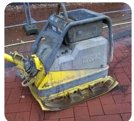
Die Pflastersteine werden in die ECOPREC®-Bettung eingerüttelt
