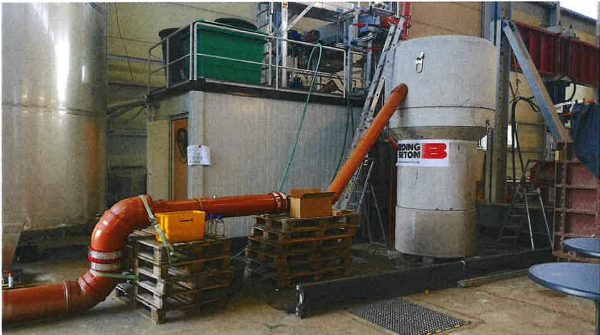
Abb. 1: Niederschlagswasserbehandlungsanlage beDrop 1000/1500 im aufgebaut im IKT-Prüfstand während der Versuchsdurchführung.
