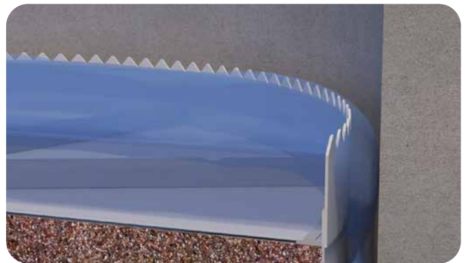
Vollflächiger Überlauf über das Zackenwehr
