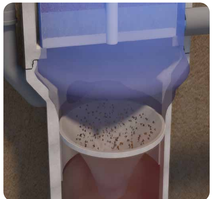
Tangentiale Einleitung und Sedimentation
