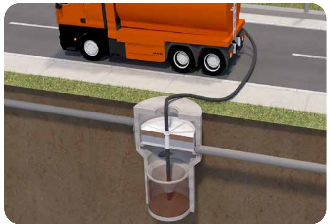
Die Schlammentsorgung erfolgt über die Inspektionsöffnung
